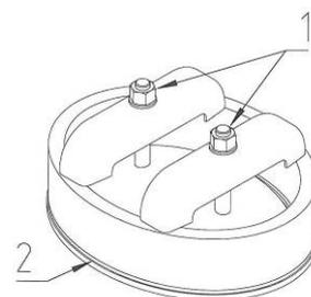
**ВНИМАНИЕ:** На генераторах, имеющих люк для внутреннего осмотра котла при первом пуске очень важно затягивать две гайки (1) дверцы люка по мере увеличения давления. В противном случае из-за утечки пара, разрушающей уплотнение (2), создается опасность для персонала котельной.
